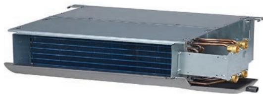
Фанкойл оснащен двумя независимыми теплообменниками воздухоохладителя и воздушнонагревателя. Такое решение позволяет поддерживать индивидуальные параметры воздушной среды в различных зонах в зависимости от предпочтения каждого пользователя. Один из фанкойлов может работать в режиме охлаждения, в то время как другой - в режиме нагрева.
