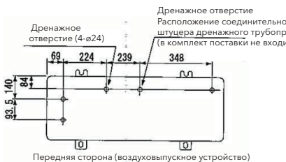
Передняя сторона (воздуховыпускное устройство)
