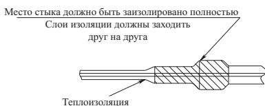
Теплоизоляцию закрепите монтажным скотчем
