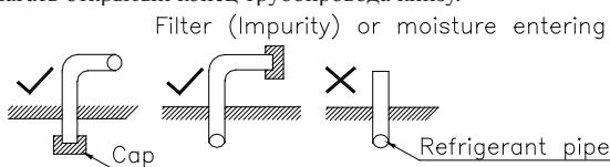
2) При подаче трубы через отверстие в стене обязательно одевайте заглушку на конец трубы.
