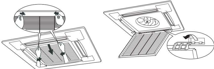
2. Смывайте грязь с сетки фильтра с помощью мягкого моющего средства, тряпочки и воды до полной очистки фанкойла.
