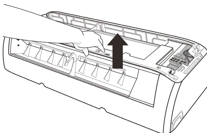
5. Вымойте переднюю панель в воде с нейтральными моющими средствами. Перед мойкой снимите дисплей с передней панели.
