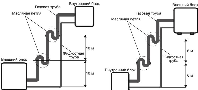
1. Внутренний блок установлен выше наружного блока
