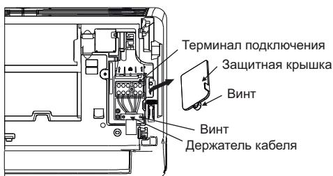
Терминал для подключения проводов
