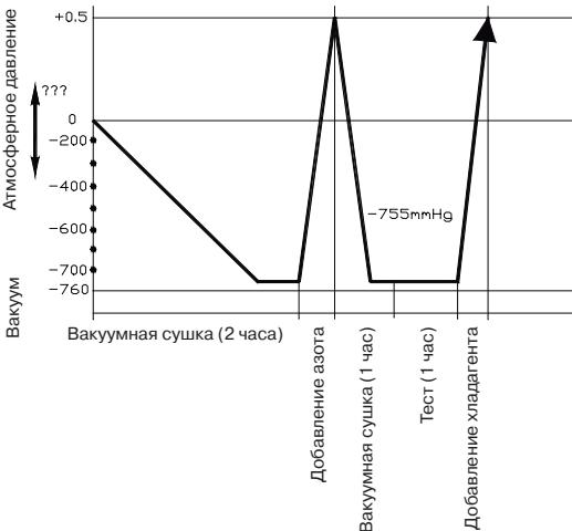
После первого вакуумирования добавьте в контур осущененный азот при давлении до 25 кг/см<sup>2</sup> на 30 минут. Удалите азот и снова отвакуумируйте систему. После проверки на утечку добавьте хладагент.
