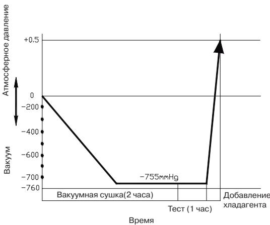
При первой установке блока на только что установленные трубопроводы нет необходимости вакуумировать систему 2 часа, при условии, что установка трубопроводов проходила при отсутствии атмосферных осадков, и при относительной влажности воздуха не более 60%. Вполне достаточно 30 минут. Если установка трубопроводов проходила под атмосферными осадками или при повышенной
