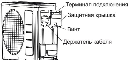
Терминал для подключения проводов
