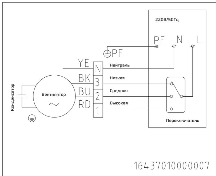
При подключении см. обозначения на клеммной колодке
