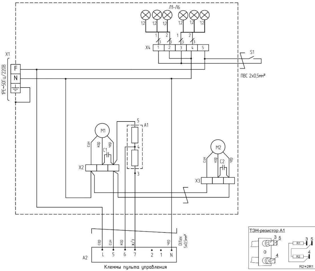
Рисунок 8-Назначение клемм пульта управления (IR03)
