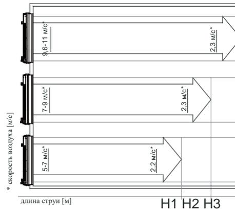
**ВНИМАНИЕ!** При выборе вспомогательной функции подогрева воздушного потока необходимо учитывать силу и направление ветра снаружи помещения. Главным критерием регулирования тепловой мощности является температура вблизи дверей внутри помещения. Также рекомендуем при угрозе попадания слишком большого количества наружного воздуха внутрь помещения включить функцию использования теплообменника. Следует учесть дополнительные факторы, влияющие на работу оборудования.
